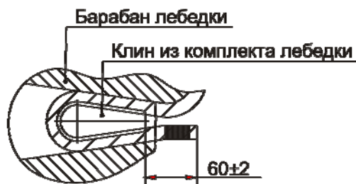
Крепление каната на барабане лебедки
