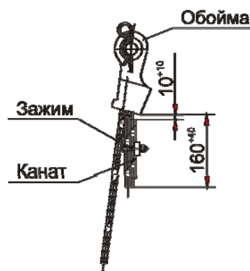
Крепление каната в клиновой обойме на оголовке стрелы
